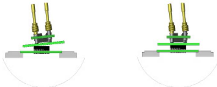
A cabeça flexível de contato com elemento de mola garante um ajuste ideal.
