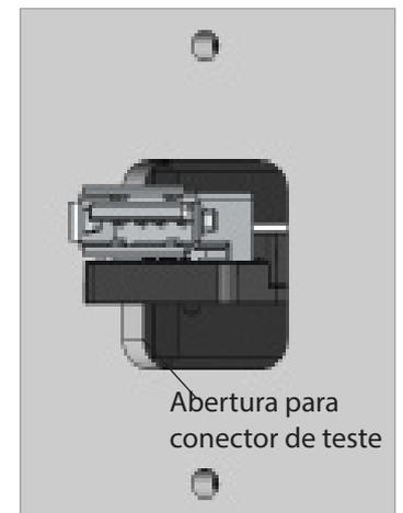
Solte o parafuso de retenção do conector de teste. Insira o conector de teste no DUT até que ele pare. Recolha o conector de teste por 0,5 a 1 mm para evitar danos ao DUT. Agora o conector de teste pode ser corrigido usando o pino rosqueado
